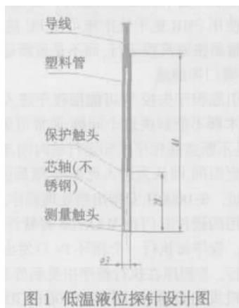
图 1 低温液位探针设计图
