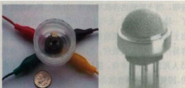
图3 新型氢气浓度探测器外型
