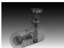
图3 溢流阀透明模型
