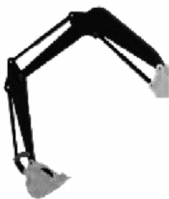
图8 运动中可能发生碰撞的液压臂X3D截图
