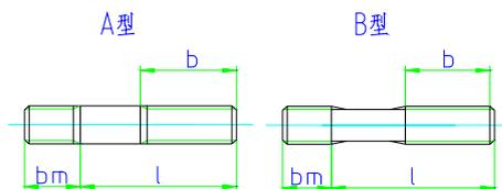
注：bm-旋入机体端，b-旋入螺母端，性能等级：4.8、5.8、6.8、8.8、10.9、12.9、A2-50、A2-70。
